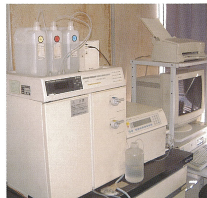
塩化物イオン量の測定状況
