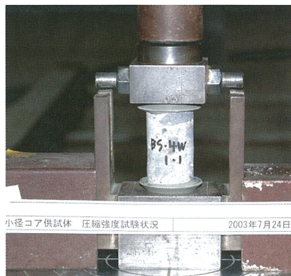
圧縮強度試験状況
