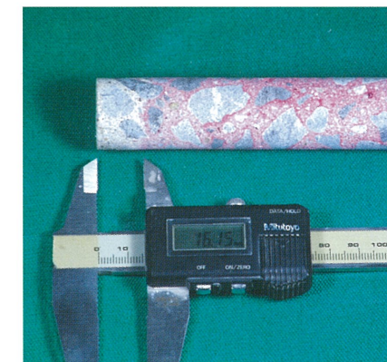
中性化深さの測定状況
